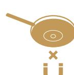
Pour savoir si une casserole convient, un aimant peut être placé sous l'ustensile pour vérifier s'il est magnétique.
