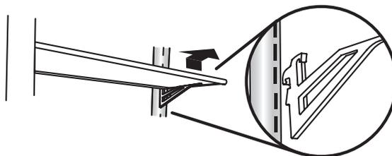
3. Placer l'arrière de la tablette dans les supports de tablette.
