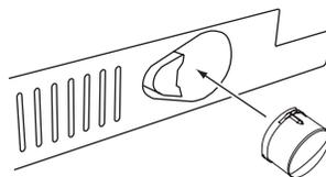
4. Tourner le bouchon dans le sens antihoraire jusqu'à ce que le bouchon glisse dans la fente de fixation. Tourner ensuite le bouchon dans le sens horaire jusqu'à ce qu'il soit en position horizontale.
